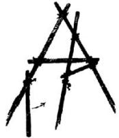
Das Schwierigste an der ganze Sache ist das Aufrichten des Tripods. Da heißt es: Vorher üben, üben, üben. Wenn alles fertig vorbereitet und geübt ist, malt ‚L‘, ‚R‘ und ‚M‘ (links, rechts, Mitte) auf die Fußenden der Stangen an der Seite, die nach oben zeigt, wenn der Tripod fertig zum Aufstellen bereitliegt. Die ‚M‘- Stange ist die, deren Fußende-Lagepunkt sich später verändert. Sie sollte vor dem Aufrichten oben liegen. Hilfreich ist, beim Üben den Ab-
