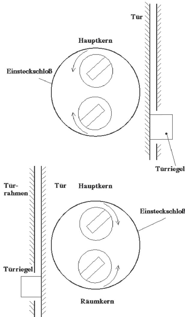
Abbildung 9.1: Die Öffnungsrichtung
