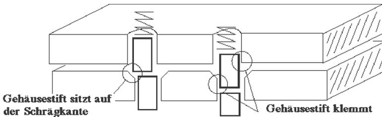
Abbildung 9.5: Der Gehäusestift sitzt auf der Schrägfläche
