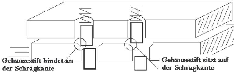
Abbildung 9.6: Der Gehäusestift klemmt in der Schrägfläche
