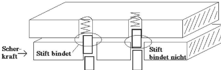
Abbildung 4.1: Einfache Kraft, die den Gehäusestift bindet
