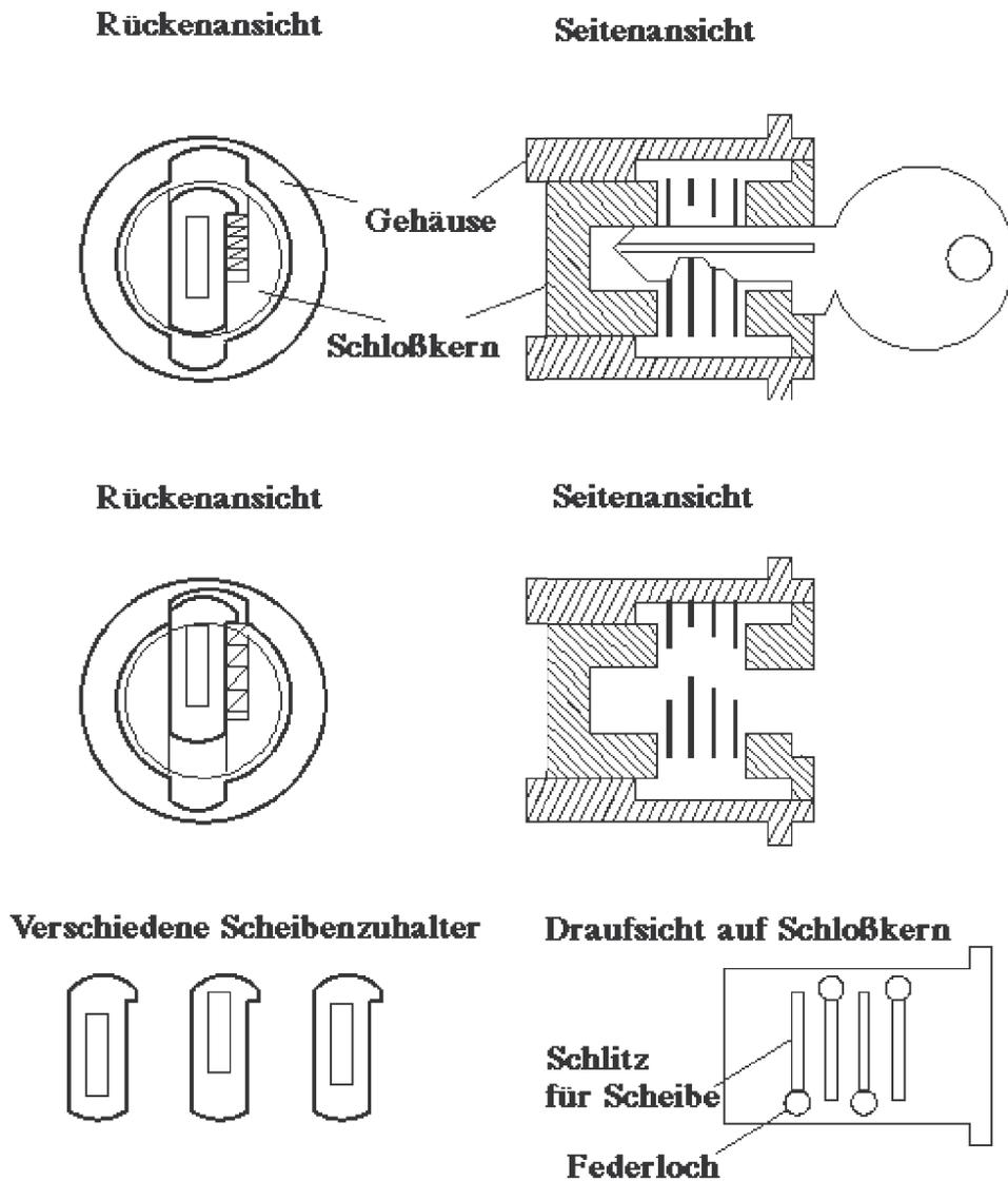
Abbildung 9.10: Arbeitsweise eines Scheibenzuhaltungsschlosses
