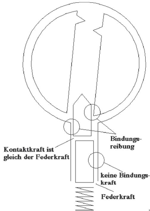
Abbildung 5.4: Der Kernstift dringt in das Gehäuse ein
