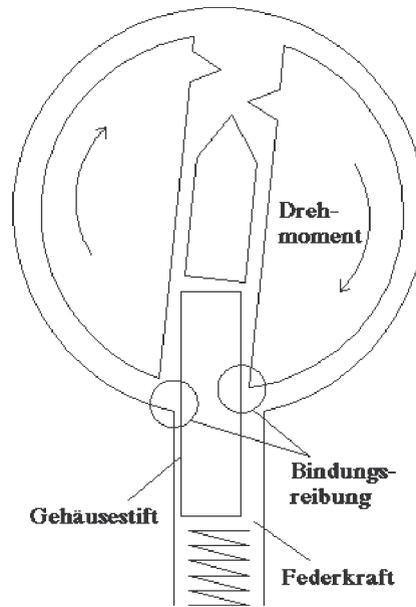
Abbildung 5.2: Der Gehäusestift ist eingeklemmt
