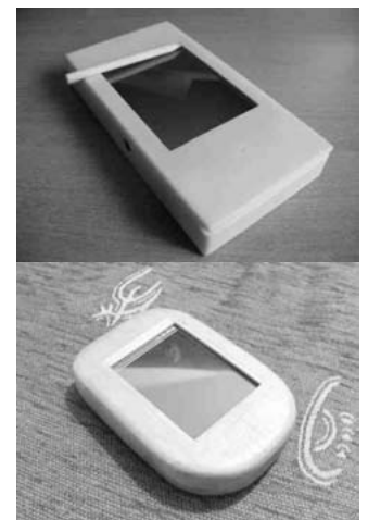
Gehäuse (v.l.n.r.): Neo Freerunner, Letux-Serie (openphoenix.org), 3D-Druck und Maßanfertigung aus Holz (r.u.)
