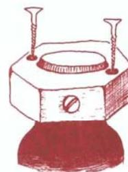
Setze noch wie in der Zeichnung zwei Holzperlen als Lagerkugeln ein. So dreht sich der Rotor besser. Nun fehlt nur noch die Windfahne, die du am anderen Ende anschraubst. Alle großen modernen Windkraftanlagen sind so aufgebaut. Sie haben meist drei, manchmal nur zwei Flügel. Bei Bremen gibt es auch große Windkraftanlagen mit einem Flügel.
