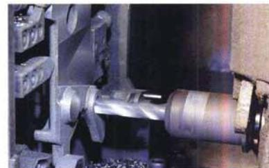
Neue Wege: Trockene Bearbeitung von Gußwerkstücken
