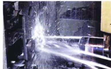
Stand der Technik: Kühlung von Werkzeug und Gußteil durch Kühlschmierstoffe
