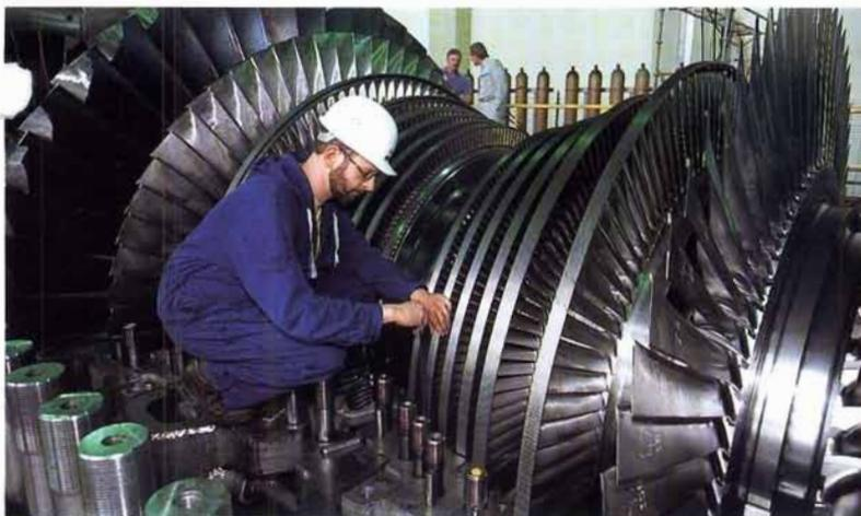
**Neue, moderne Schaufeln für die Dampfturbinen bringen höheren Wirkungsgrad**
