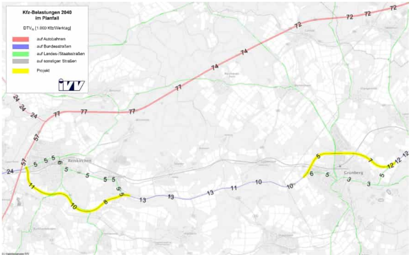
Abb. 3: Kfz-Querschnittsbelastungen des DTW w in Zielnetzprognose 2040 (Mit-Fall)
